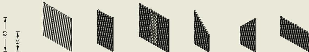
Portal-Tor mit Alurahmen, inkl. Sichtblende, Schlosskasten, Drücker u. Bänder, (Profilzylinder bauseits)
