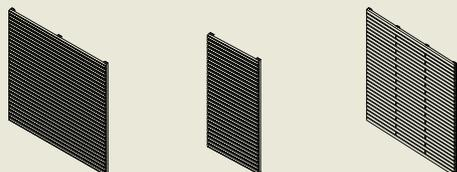
Einzelne Rhombusleisten 23/56 mm, keilgezinkt Lagerlänge 6 m
