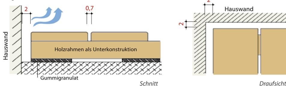
Hinterlüftung mit Mähkante Randstein & Unterbau mit Pflasterstein
